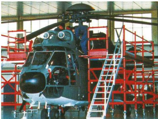
Fiberglasdock für Rotor und Heck des Superpuma
