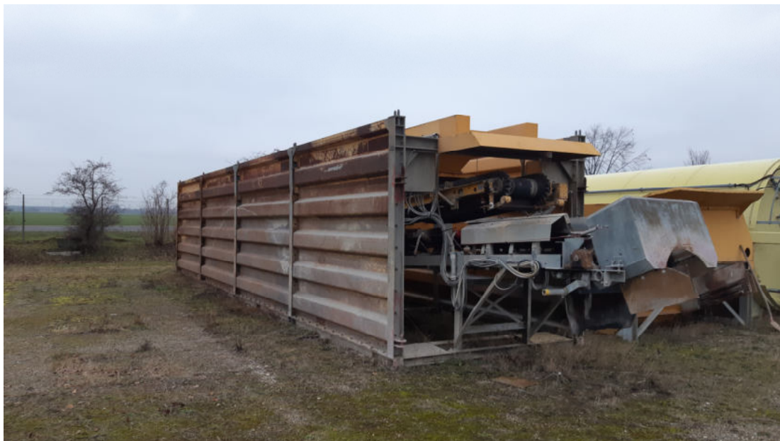
Zuschlagdoseunterteil (Lager, Abwurfseite)
